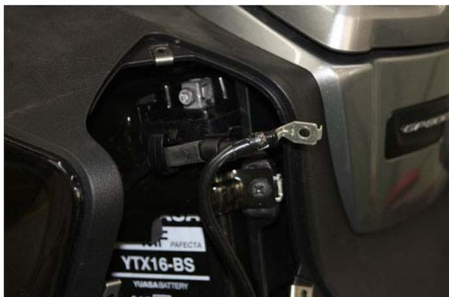
Scollegare i cavi della batteria per evitare danni all'impianto elettrico
