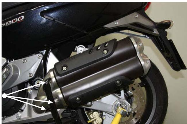
Rimuovere la protezione paracalore, svitando le 3 viti indicate in figura
